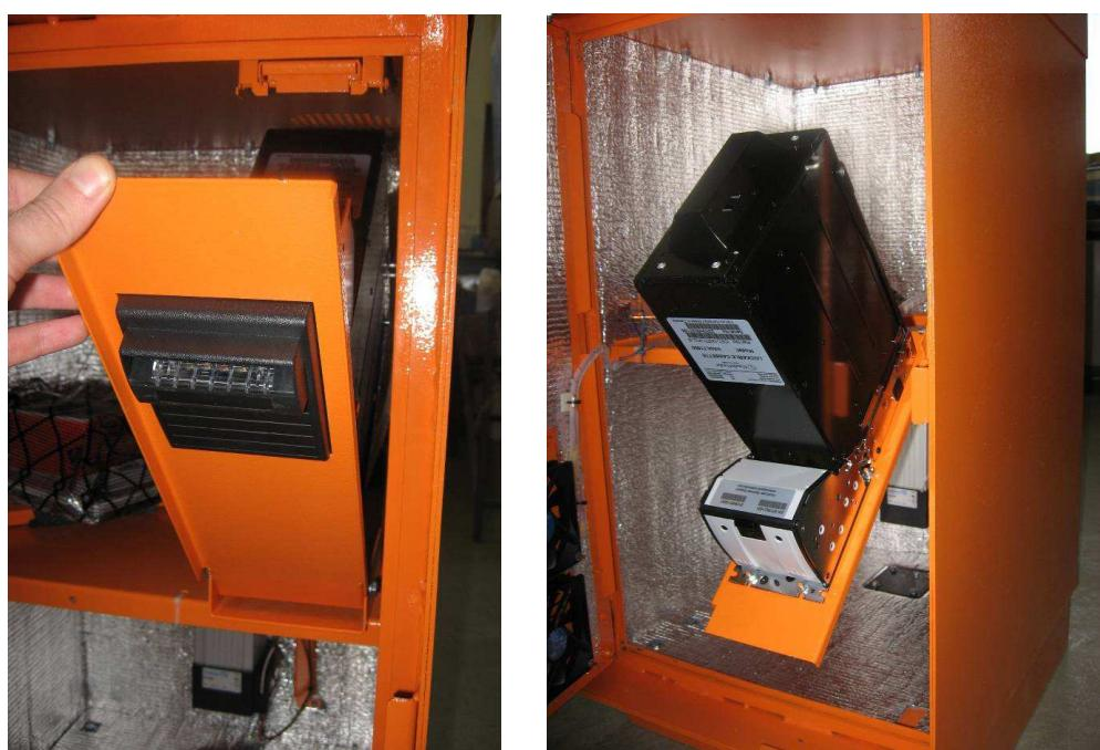
4. Снять денежную кассету из крепления купюropриемника (см. Рис. 14.)
