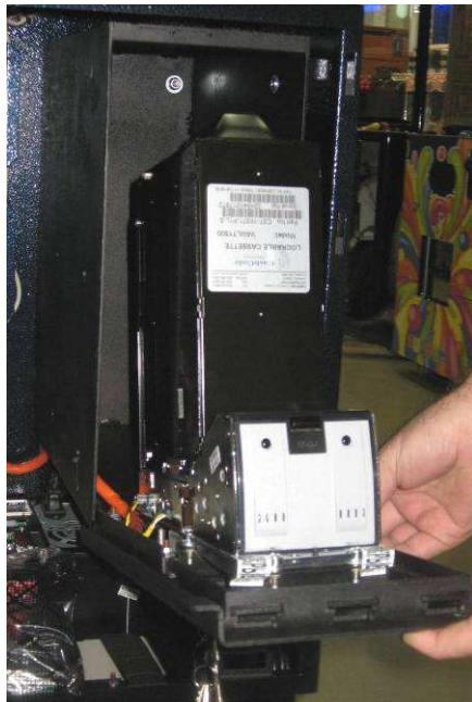
3. Снять денежную кассету из крепления купюropриемника (см. Рис. 12.)
