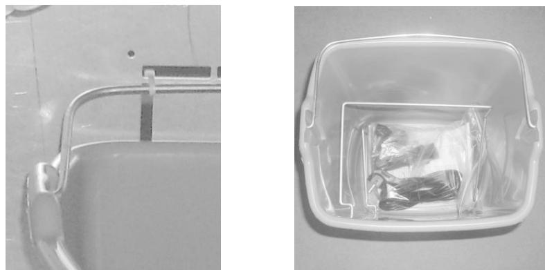
Рисунок 3 — Контейнер жидкого отходов, закрепленный пластиковыми стяжками.
