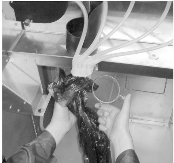
Рисунок 21 — обжим пакета для сбора твердых отходов.
