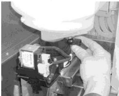
Рисунок 23 — регулировка качества помола.
