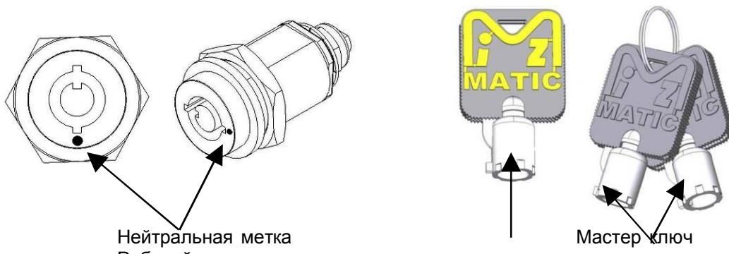
Рисунок 36 — внешний вид замка Mizmatic.
