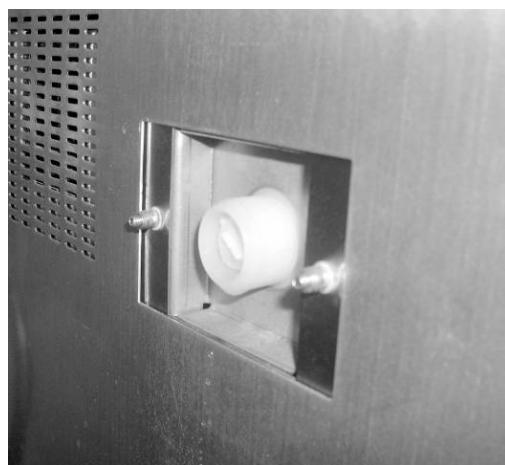
Рисунок 38 — водорозетка электроклапана для подключения к водопроводной сети.
