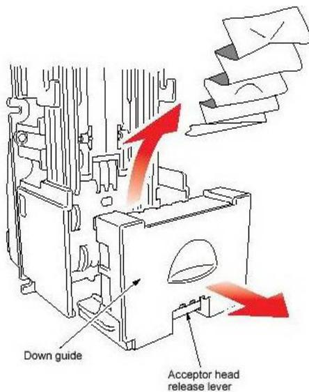
Рисунок 40 — извлечение замятой банкноты из приемной части купюроприемника.
