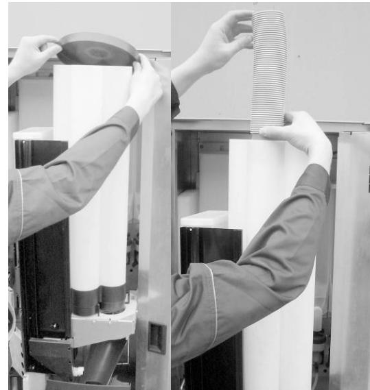
Рисунок 17 — обслуживание диспенсера стаканов
