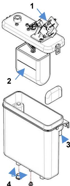
Рисунок 28 — поплавковая камера.
