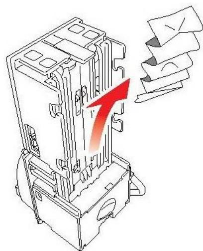
Рисунок 41 - извлечение замятой банкноты из корпуса купюроприемника
